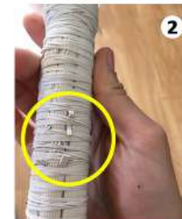
Exemplos de fios centrais danificados
