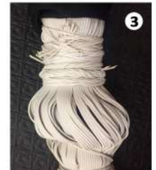
Exemplos de fios secundários fora de sua posição
